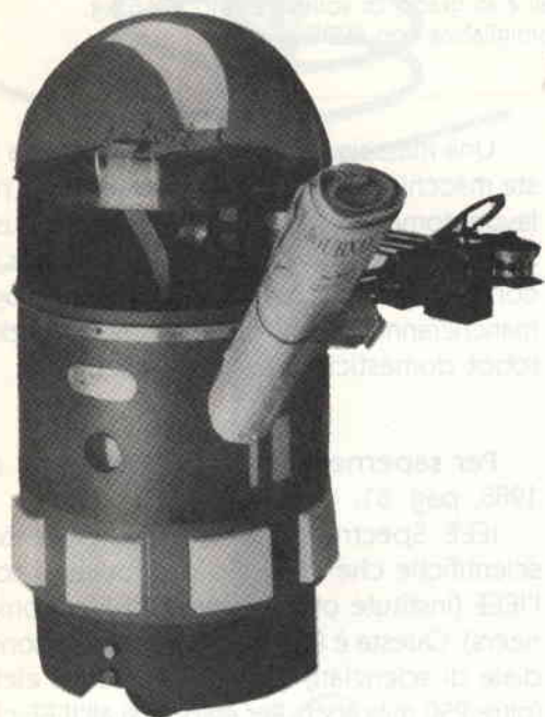
figura 3 - Il robot RB5X ha un braccio retraibile all'interno del corpo. Attorno alla base vi sono dei sensori di ostacoli.
